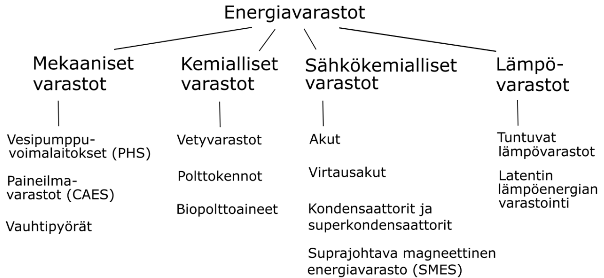
Kuva 3. Käsitekartta energiavarastoista. Pumppuvoimalaitokset kuuluvat mekaanisiin varastoihin. (Alami 2020, s. 7.)
