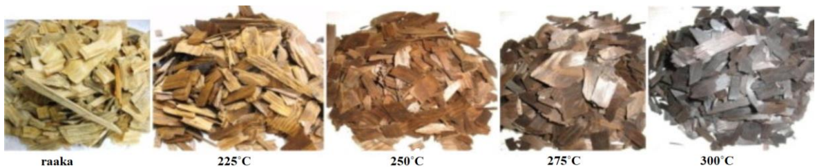
Kuva 14. Torrefioitua puuhaketta. (Phanphanich, Mani 2011.)
