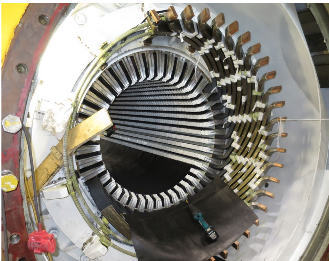
Kuva 12. Dolmel generaattorin staattorin uudelleenkäämintä
