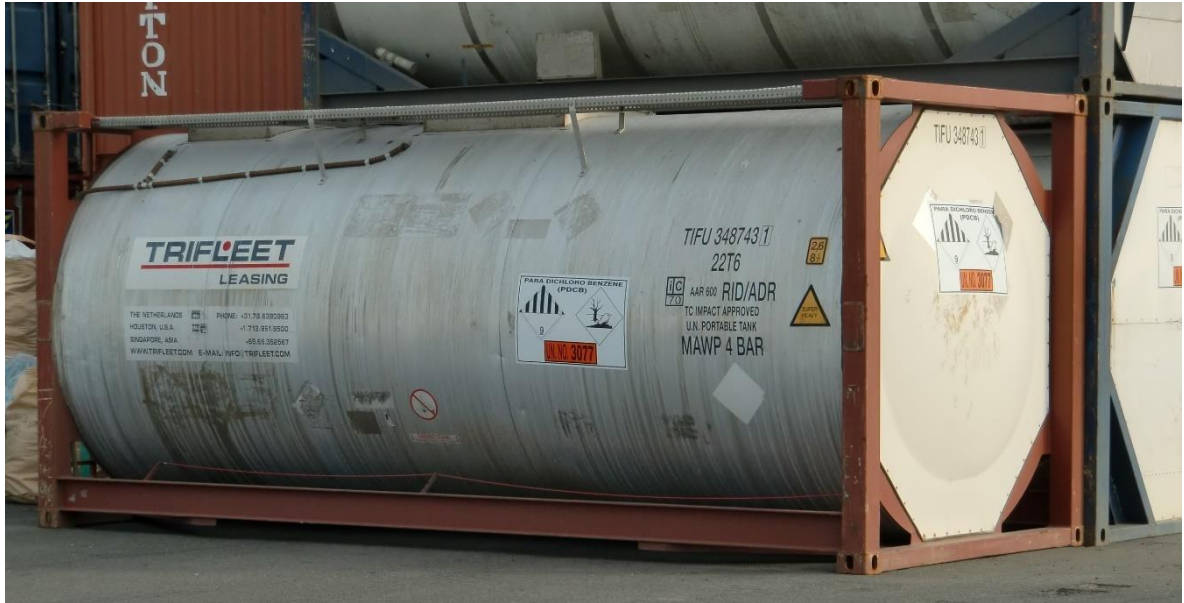
Kuva 17. ISO säiliökontti (Gazouya-japan 2011)
