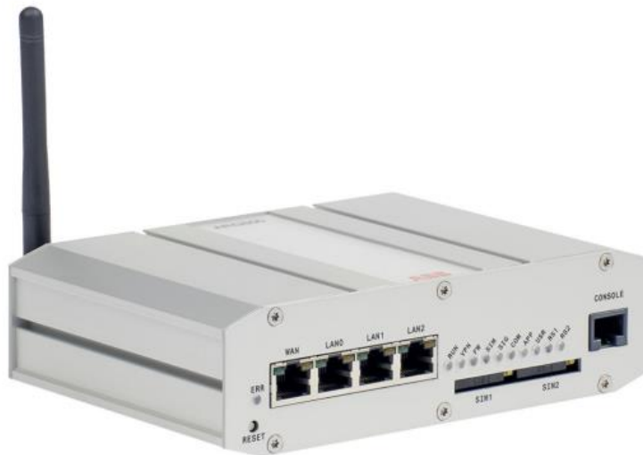
Kuva 7.8 ARG600 gateway-laite (ABB, 2020)
