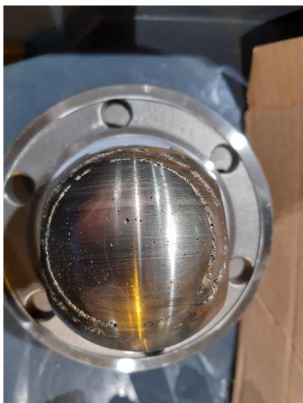
Kuva 12. Happaman väliaineen aiheuttamat vauriot palloventtiilin sulkuelimessä.
