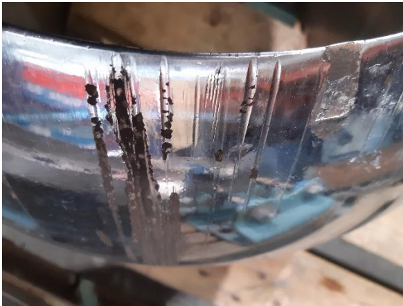
Kuva 10. Epäpuhtauden aiheuttamat mekaaniset vauriot palloventtiilissä.
