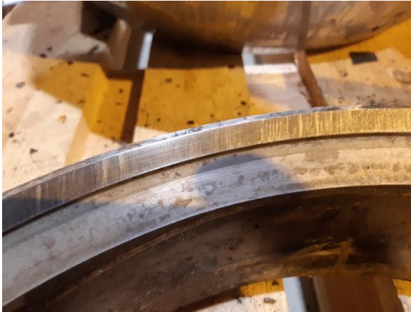
Kuva 8. Kulunut palloventtiilin tiiviste.
