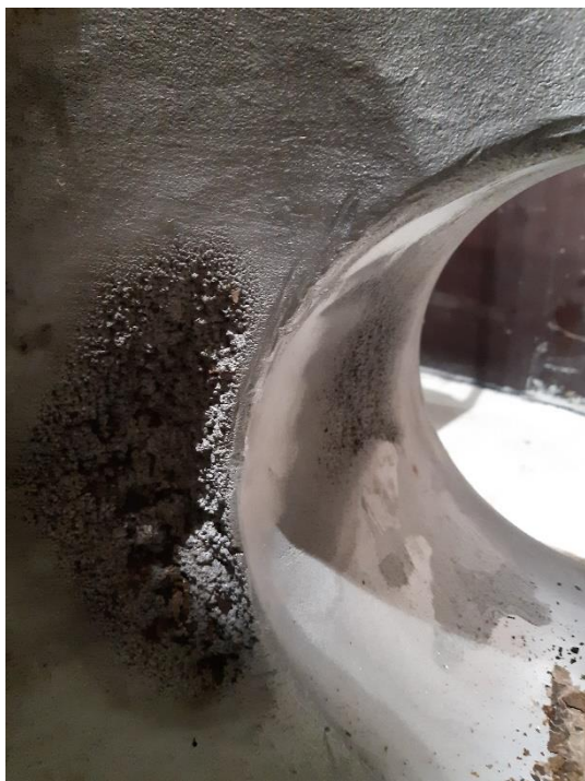
Kuva 13. Kavitoinnin vauriot venttiilirungossa.
