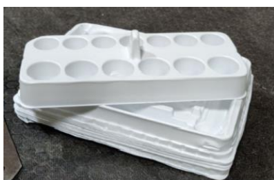
Figure 21. Pipette tip boxes of made from (PP) (© L&T Ympäristöpalvelut Oy).
