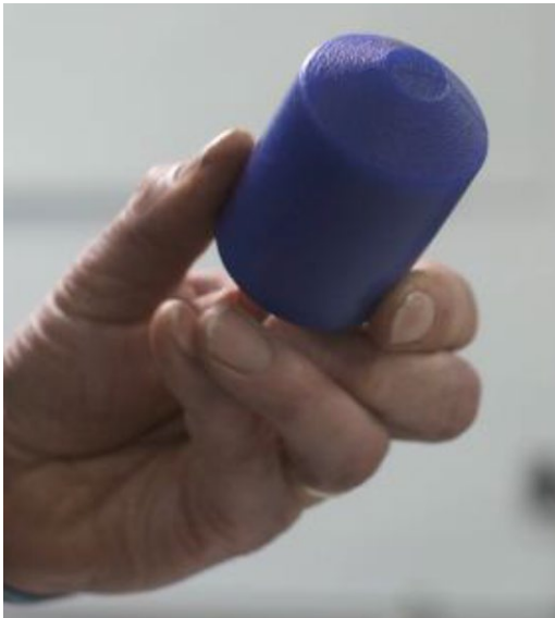
Kuva 4. Piggin-prosesissa käytettävä ”possu”. (Elgar 2021.)
