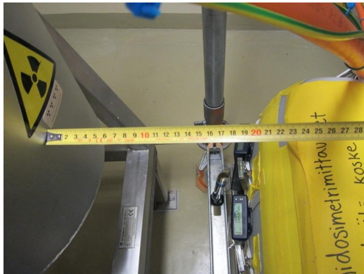
Kuva 9. Mittausfantomin etäisyys boorianalyssaattorista
