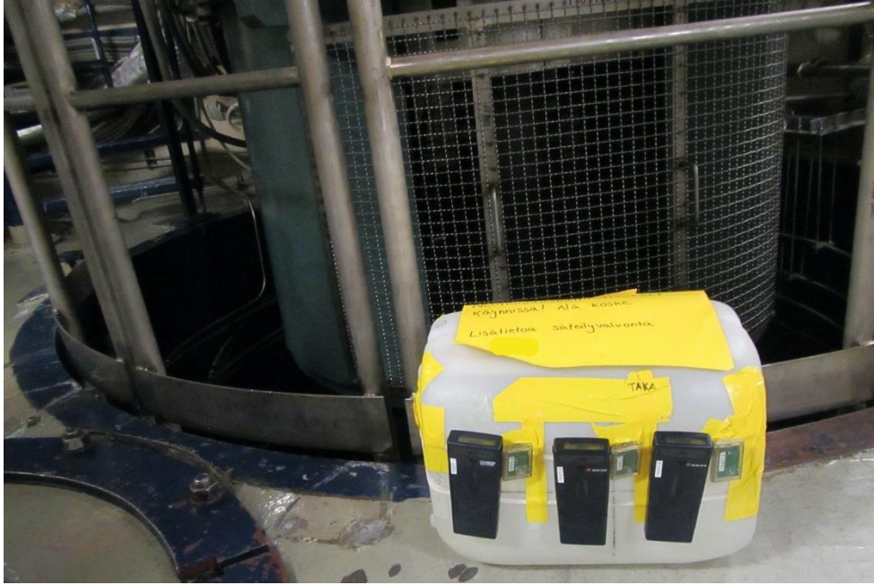
Kuva 6. Neutronimittaukset LO1:n pumppukuopalla.
