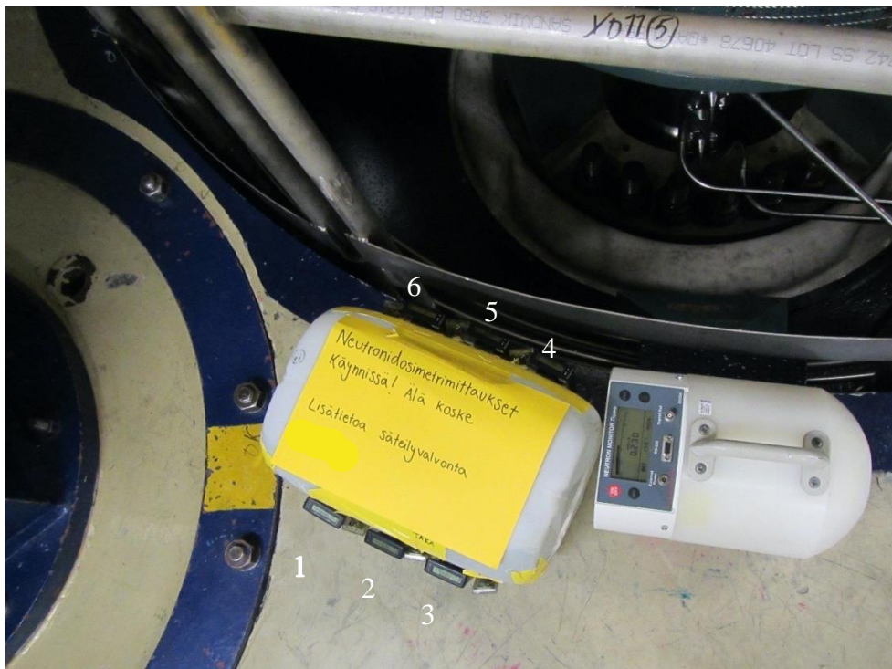
Kuva 7. Neutronimittaukset LO2:n pumppukuopalla, merkittynä dosimetrien paikkanumerot 1-6
