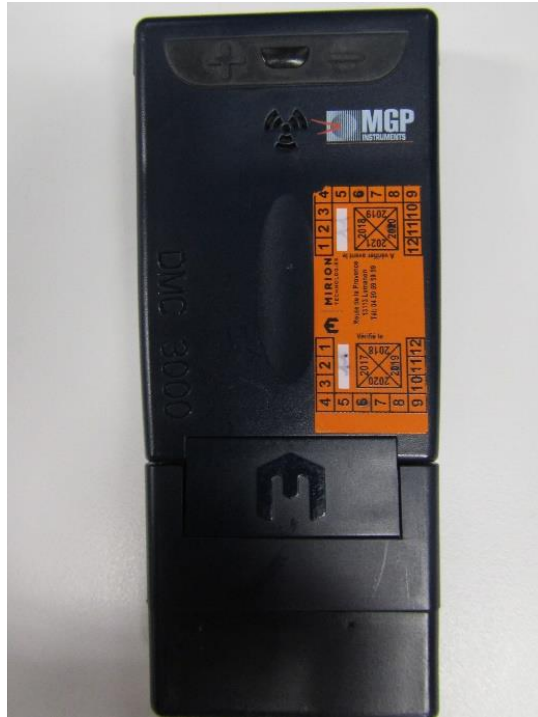
Kuva 1. Elektroninen dosimetri neutronimoduulilla
