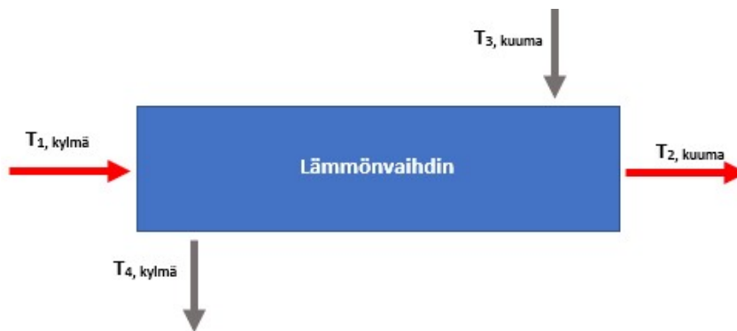
Kuva 6 Esimerkki vastavirtalämmönvaihtimen fluidien virtaussuunnista, muokattu Suomenkieliseksi [12]
