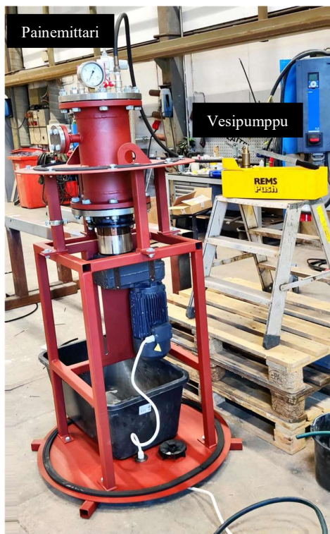
Kuva 6. Korkean paineen mittausjärjestelmä
