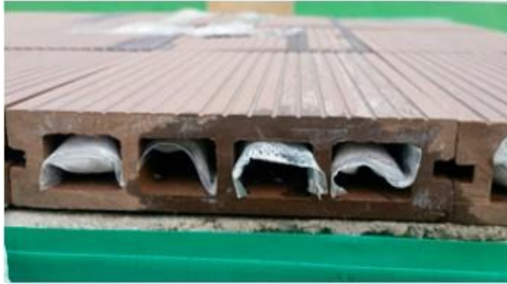
Kuva 11. Puumuovikomposiitista valmistettu kattolaatta, jonka sisällä on faasimuutosmateriaalia (Chung & Park 2017, 3).
