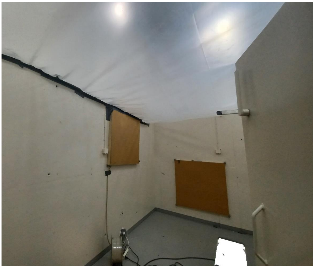
Kuva 11. 23,5 m 3 testikammio alennetulla katolla. Kuva ovelta päin. Letku seinällä on aerosolin syöttöpaikka ja testattava ilmanpuhdistin kuvassa oikealla alhaalla.
