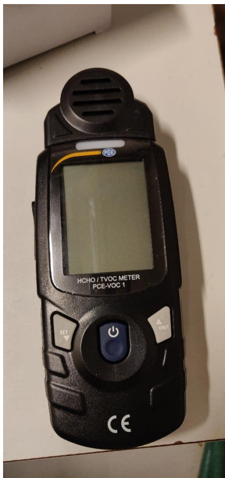
Kuva 14. TVOC-pitoisuuden mittaukseen käytetty PCE Instrumentsin PCE-VOC 1 HCHO/TVOC-mittari.
