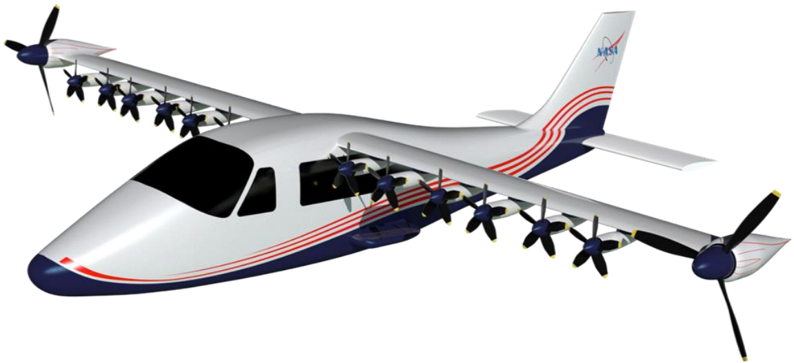
Kuva 4.1. NASAn X-57 Maxwell -sähkölentokonekonsepti. Siivissä on yhteensä kaksitoista pienempää moottoria ja kaksi isompaa moottoria. (NASA 2022)
