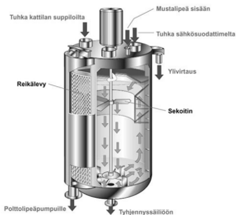
Kuva 16. Sekoitussäiliön toimintaperiaate (KnowPulp, 2022)
