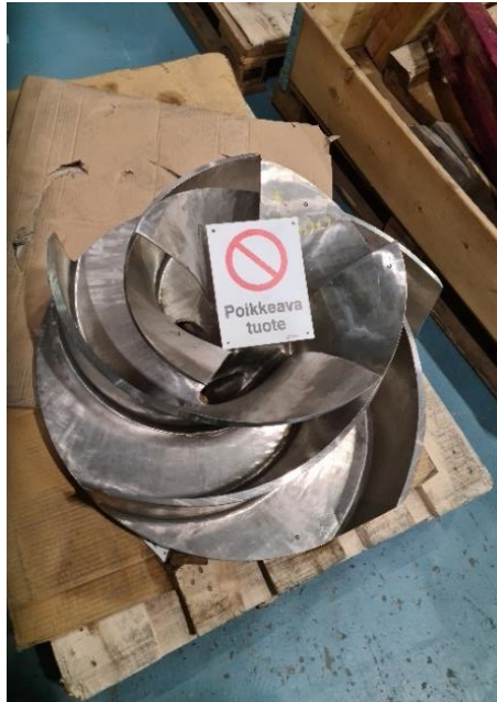
Kuva 9. Poikkeava juoksupyörä, jossa muotovirhe. Kuva on otettu Karhulan pumpputehtaalla 2022.
