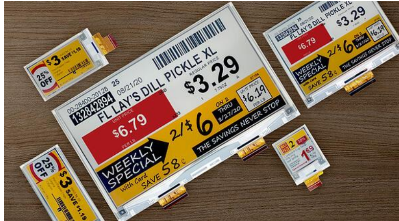
Kuva 13. E Ink Spectra 3100 hyllyetiketti (Eink 2021).
