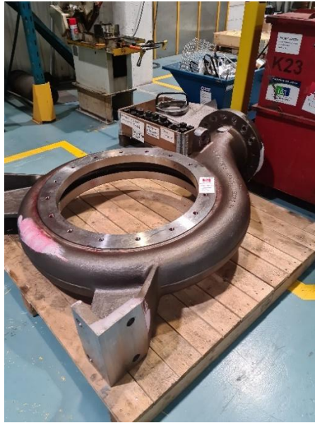
Kuva 10. Vuotava pumpun pesä. Kuva on otettu Karhulan pumpputehtaalla 2022.
