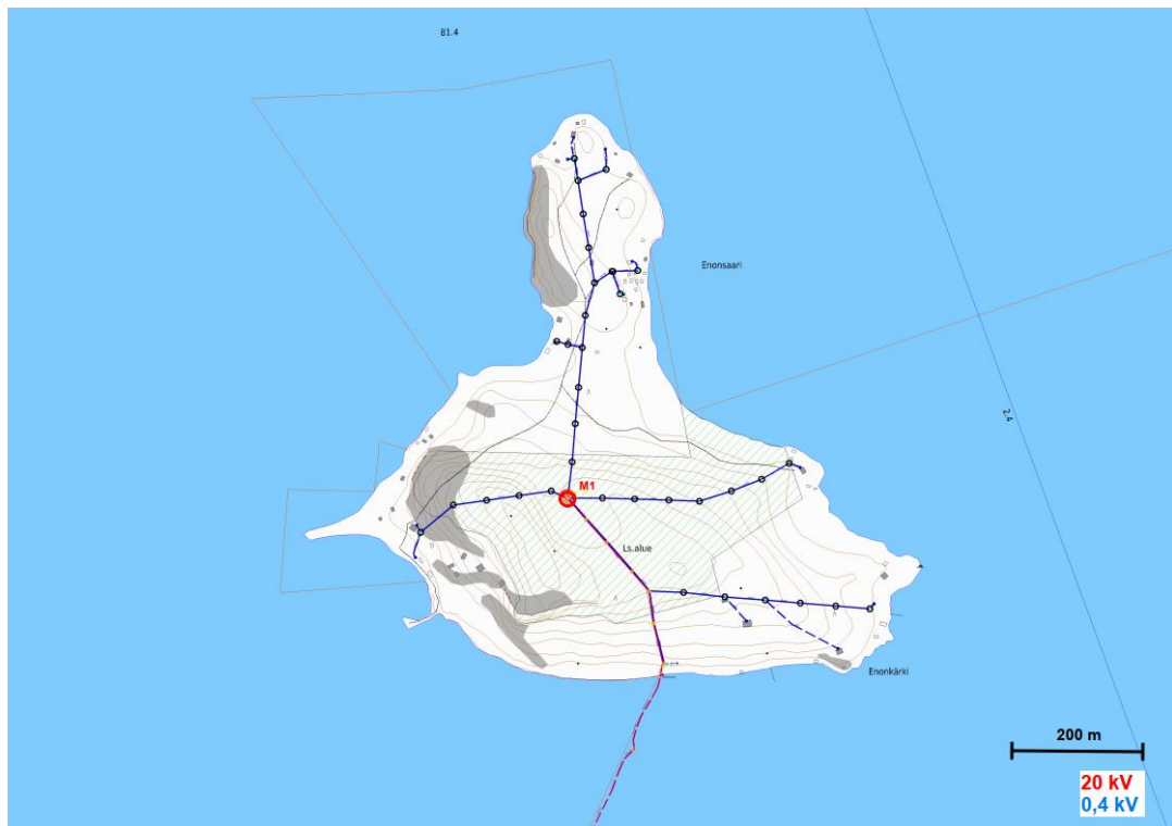
Kuva 5.9 Enonsaari ratkaisuna ilmajohto (LES, 2022c) [Muokattu]
