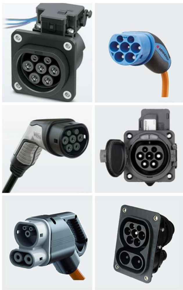
Kuva 2.1. Ylhäällä vasemmalla on Type 2 pistorasia ja oikealla sen vastakappale pistotulppa. Keskellä ovat ajoneuvon puolen vastaavat Type 2 pistokytkimen osat, vasemmalla latausjohdon pistoke ja oikealla kojevastake. Alhaalla vasemmalla on CCS 2:n pikalatauspistoke ja oikealla CCS 2 Combo ajoneuvovastake. (Mennekes, 2018; Phoenix contact, 2022)
