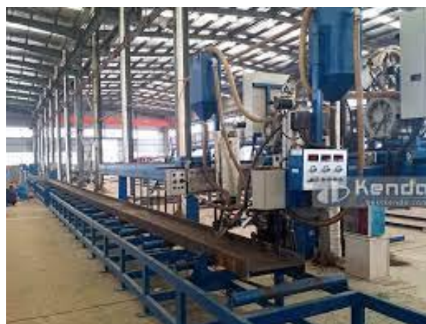
Kuva 3. I-palkin valmistus (bestkenda.com)
