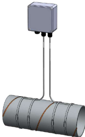
Kuva 15. Lämpötila-anturin asennustapa putkeen. (Lapp automaatio Oy, 2022)
