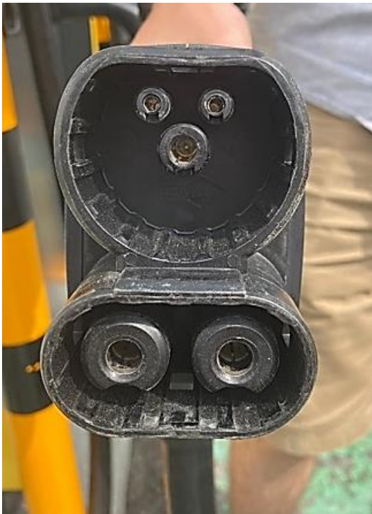
Kuva 7. CCS Combo 2 ja CHAdeMO pistokkeet.
