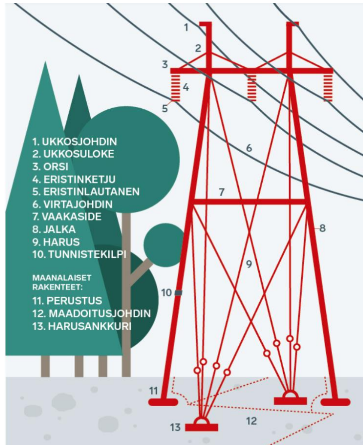
Kuva 2.3. Voimajohtopylvään pääosat. (Fingrid, 2022d).
