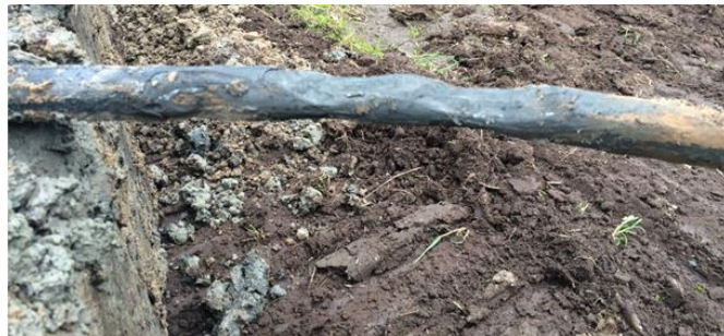
Kuva 7.6. Sulfidisaven syövyttämä kaksoissilmukka. (Fingrid, 2015).
