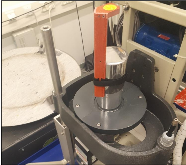
Kuva 6.1. ISOXSRCE-testilähde kiinnitettynä mittausasentoon detektoriin b19116.
