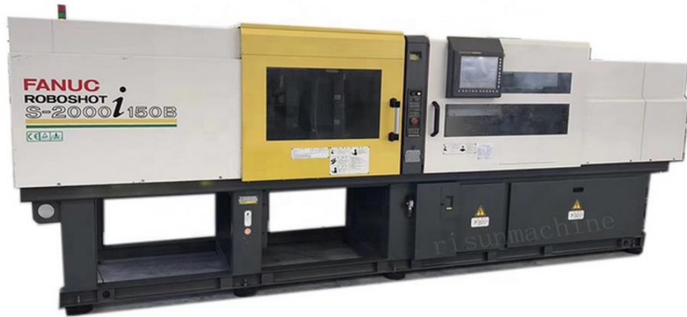
Kuva 9. Fanuc ROBOSHOT S-2000i150B ruiskuvalukone (Alibaba 2022).
