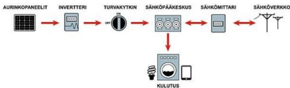
Kuva 4. Verkkoon kytketyn aurinkosähköjärjestelmän toiminta (Motiva, 2022b).
