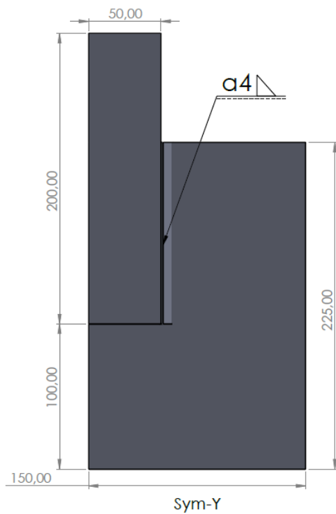
Kuva 9. Referenssitapauksen puolimallin geometria
