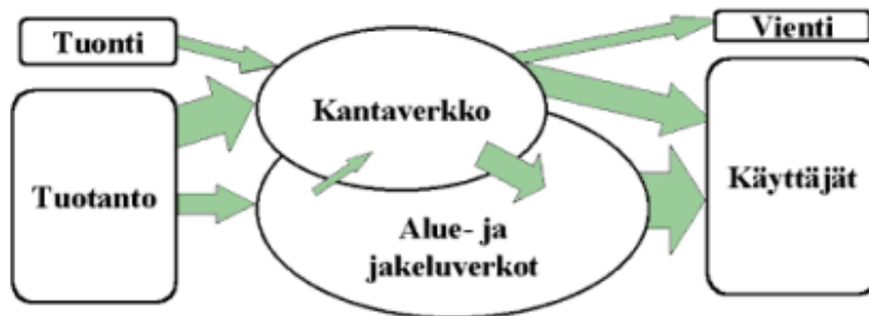
Kuva 9. Sähkön siirto ja jakelu (Partanen 2019a, 9).
