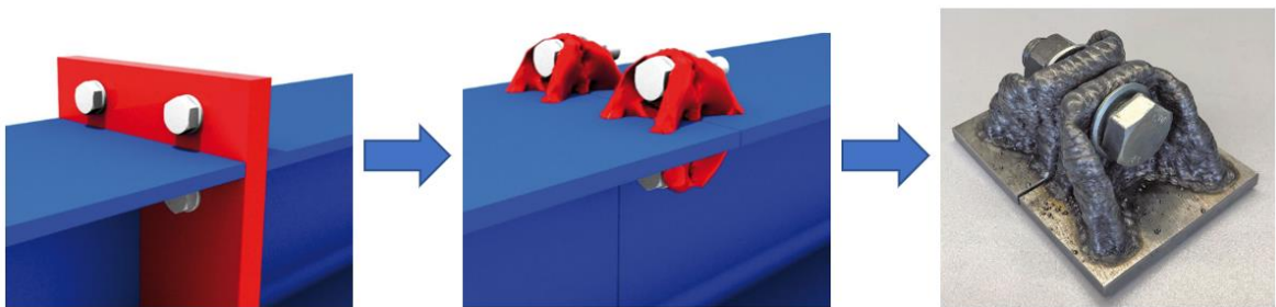
Kuva 14. Topologinen optimointi. (Lange et al. 2021. s. 145.)
