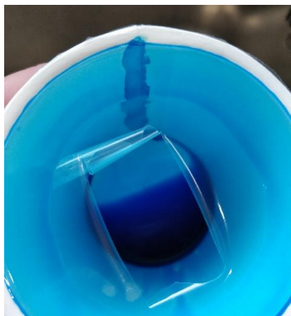
Kuva 28. Epoksilla suojattu raakareuna, jossa etanolia päässyt sauman kohdalta kannen alle.
