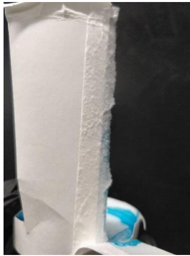
Kuva 15. Epoksin ja PE kupin välillä syntynyt kuiturepeämä.
