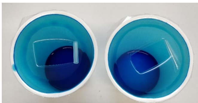
Kuva 27. Vasemmalla raakareunateipattuun kuppiin huonosti kiinnittynyt kansi, oikealla tiiviisti kiinnittynyt kansi.
