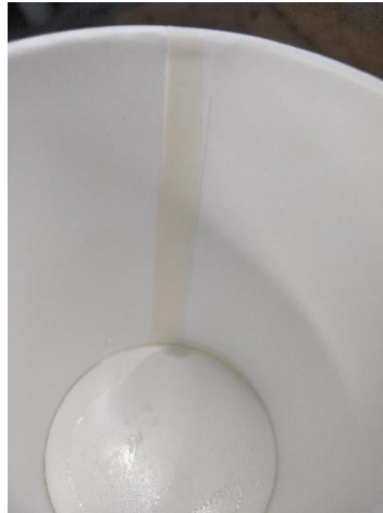
Kuva 18. Sprayliiman aiheuttama reunaimetymä suojausvaiheessa.
