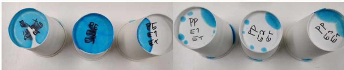
Kuva 25. Vasemmalla PE kupprien ja oikealla PP kupprien pohjat etanolitestien jälkeen.
