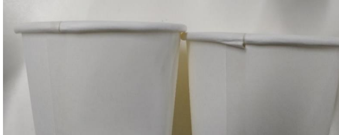
Kuva 14. Raakareunateipatut PE-kupit, joista vasemmalla parempi kuppi onnistuneella suurullalla ja oikealla huonosti muotoutunut suurulla.
