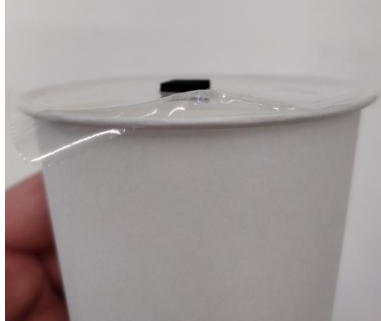
Kuva 29. Epäonnistunut kupin kannen saumaaminen.
