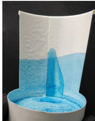
Kuva 24. Sprayliimalla suojatussa kupissa tapahtunutta reunaimeytymää.
