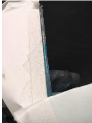
Kuva 16. Kupista irronnut epoksiliima.
