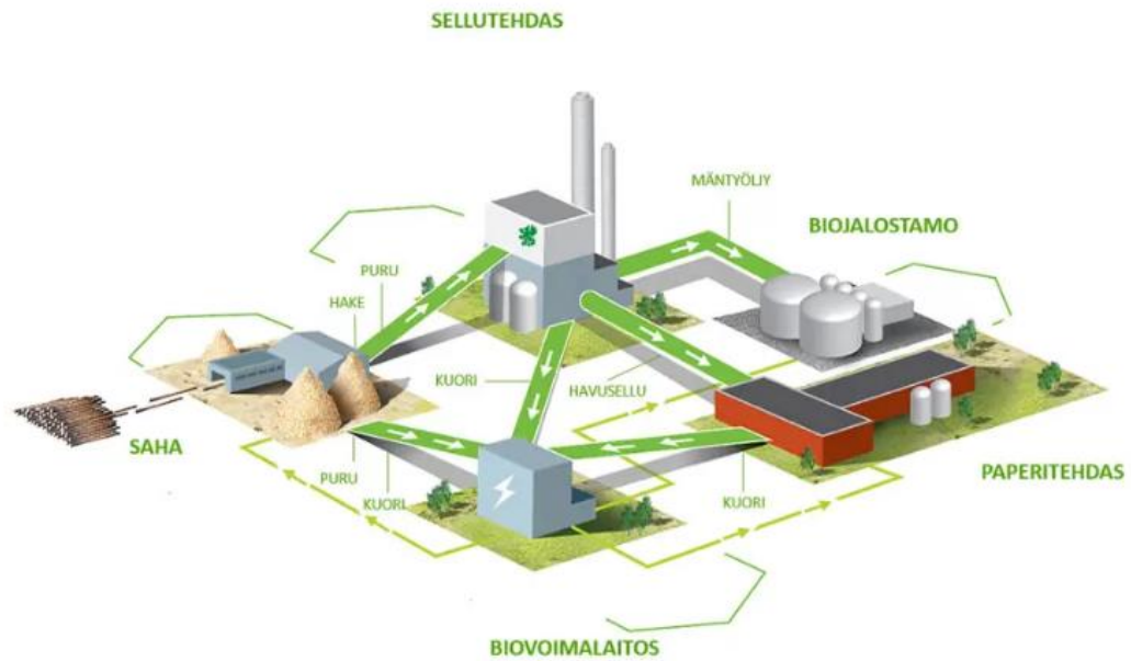
Kuva 5.2 Tehdasintegraatin rakenne ja eri osien yhteistyö (UPM, 2023)
