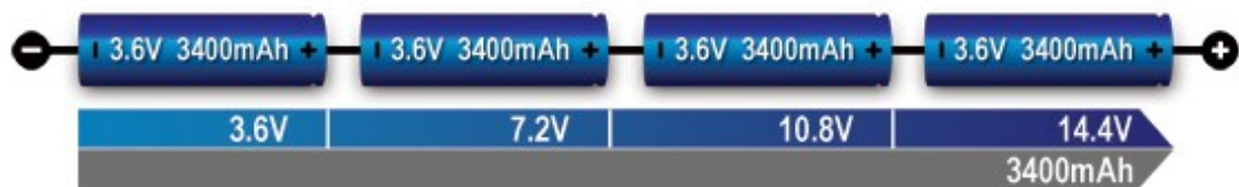
Kuva 1. Havainnekuva neljän kennon sarjakytketystä ketjusta ja sen jännitteestä ja kapasiteetista (BatteryUniversity, 2021a).
