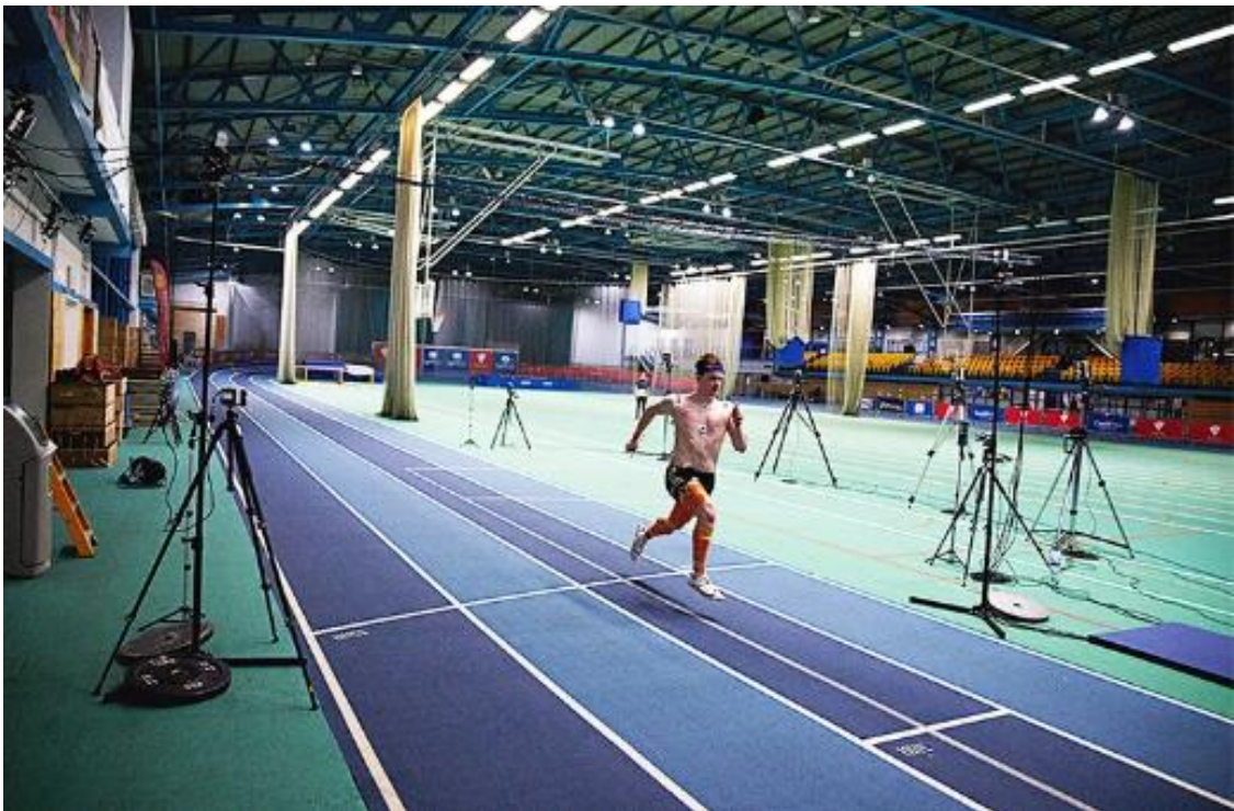
Kuva 7. Viconin juoksutekniikkaa analyysoiva optinen järjestelmä. Juoksijaan on kiinnitetty myös Viconin inertianmittausyksiköitä. (Vicon, 2021)
