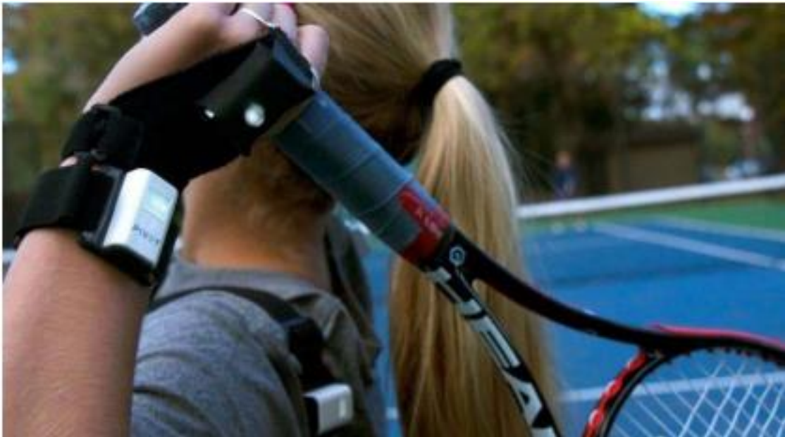
Kuva 4. IMU:ja käytetään mittaamaan tennispelaajan lyöntimääriä ja tarkkuutta (Rana, 2021).
