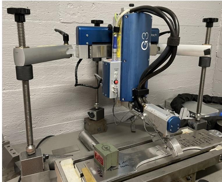
Kuva 6. Röntgendiffraktio laitteella mitataan 8 mm paksuista MIG-hitsattua koekappaletta.
