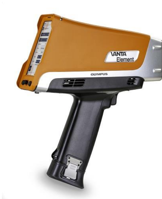
Kuva 4. Kenttäolosuhteissa toimiva XRF- analysaattori. (GWM engineering 2019)
