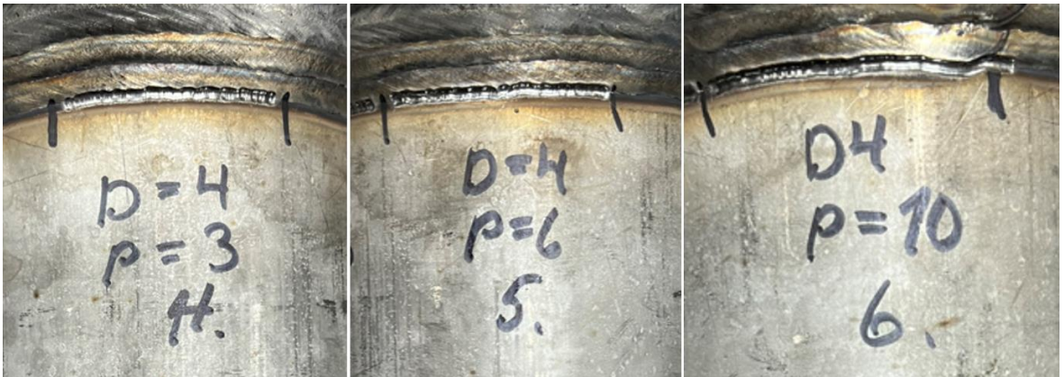
Kuva 14. Jälkikäsitteilyn vaikutus rajaviivaan eri prosessiparametreillä 316 L-teräksellä
