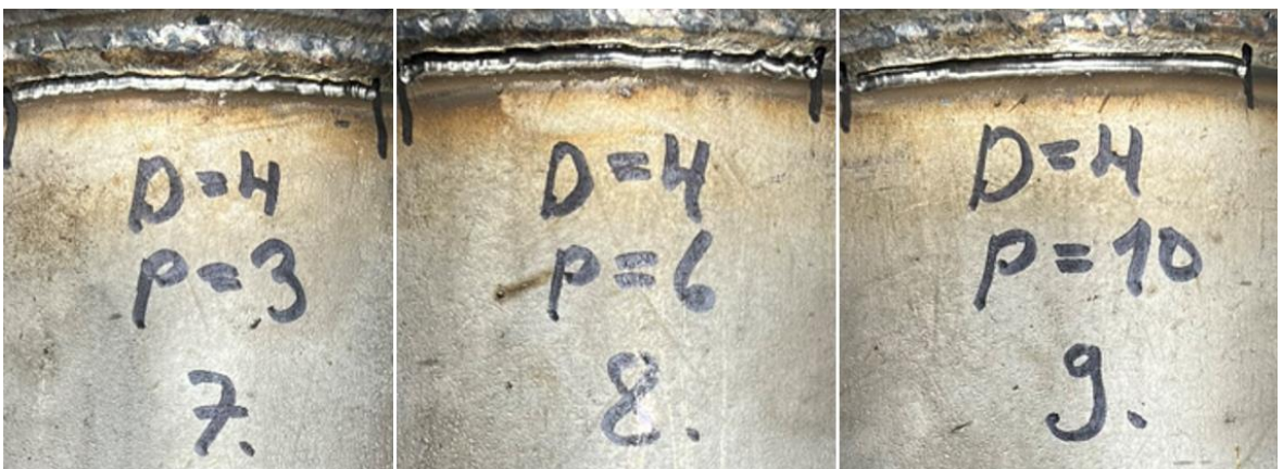
Kuva 15. Jälkikäsitteilyn vaikutus rajaviivaan eri prosessiparametreillä 904 L-teräksellä
