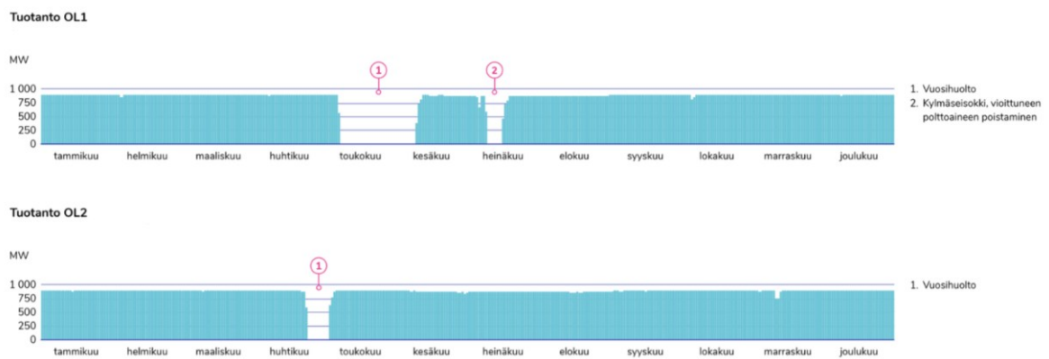
Kuva 10: Olkiluoto 1 ja 2 keskimääräinen sähköteho vuonna 2022. (TVO, 2025a)
