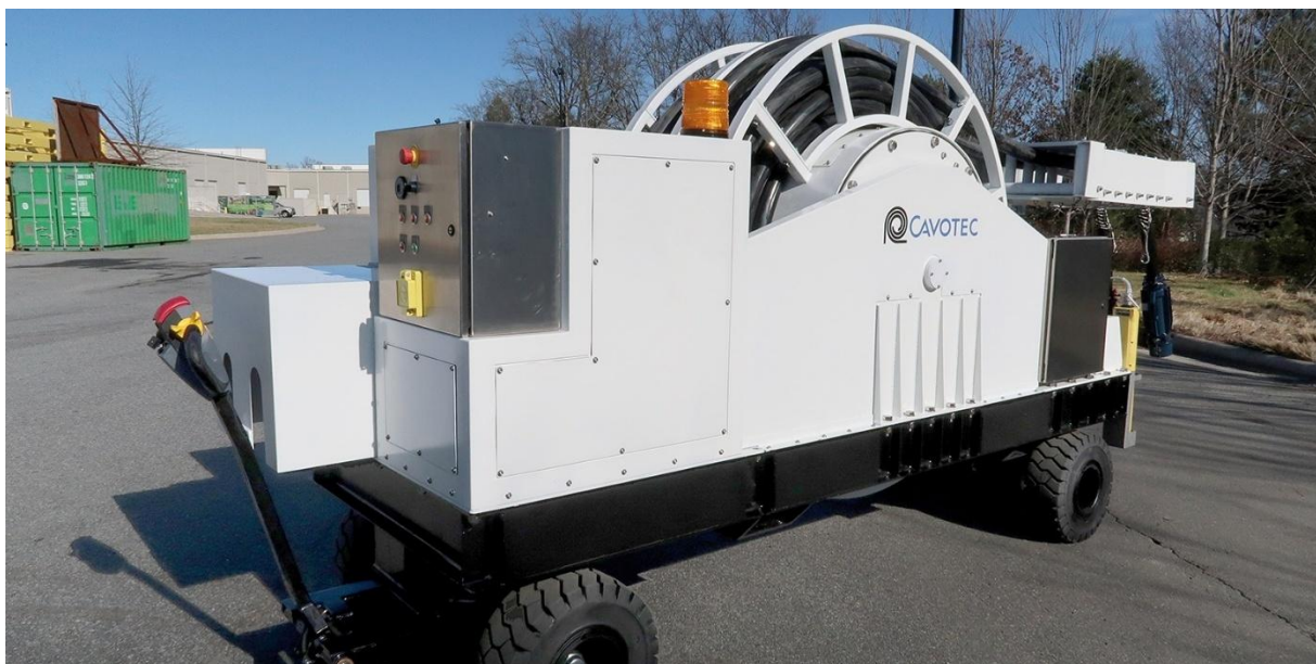
Kuva 2. Mobiili akkukäyttöinen ajettava jatkokela Cavotec PowerExtend (Cavotec Group AB, 2025).
