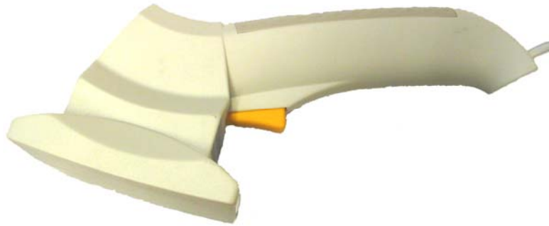
Kuva 21. Testeissä käytetty FEIG PRH100-lukulaite
