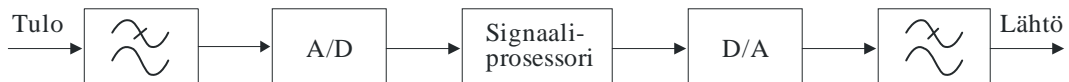
Kuva 2.1. Sulautetun järjestelmän lohkokkaavio, jossa on yksi analoginen tulo ja lähtö. Muunnos analogisen ja digitaalisen osan välillä tehdään AD- ja DA-muuntimilla.
