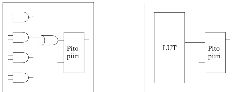
Kuva 2.4. FPGA:n logiikkalohkojen rakenne. Vasemmalla on OTP-lohko (One Time Programmable), jonka lähtö määräytyy konventionaalisten logiikkaporttien välille muodostetuista kytkennöistä. Oikealla on SRAM-pohjainen lohko, jonka lähtö määräytyy uudelleenohjelmoitavan hakutaulun (LUT, Look Up Table) mukaan. Logiikkalohkojen lähdössä on pitopiiri sekventiaalisen logiikan muodostusta varten. (kuva: Parnell 2003)
