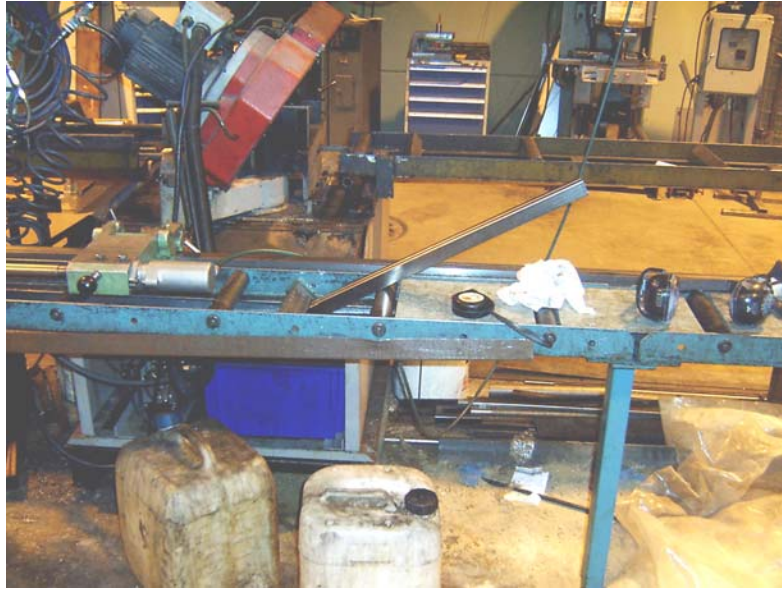
Kuva 11. Leikkausnesteen valuttaminen putkiprofilista leikkauksen jälkeen.
