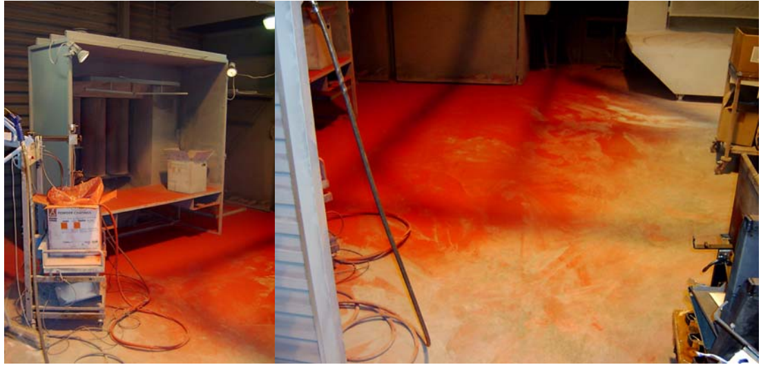
Kuva 9. Pulverimaalin talteenoton epäonnistuminen.
