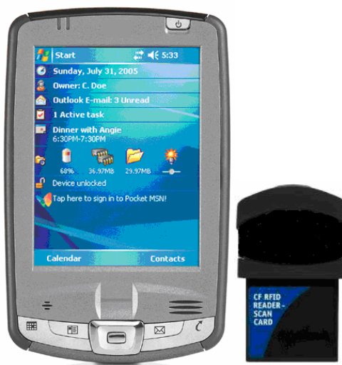
Kuva 4.5 Työmaapilotoinnissa testattava päätelaite ja siihen liitettävä RFID- lukijamoduuli.
