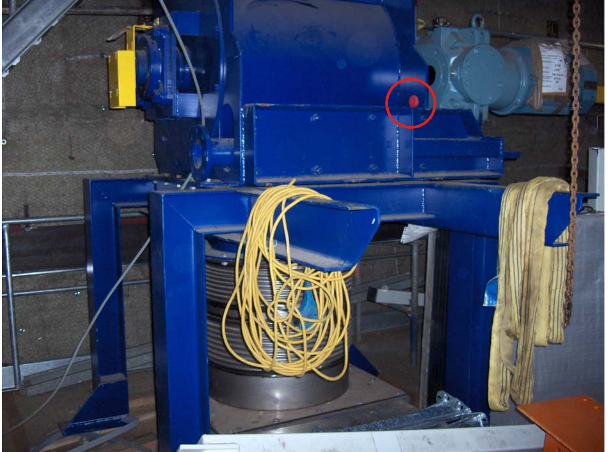
Kuva 4.3 Sulkusyöttimeen kiinnitetty punainen eTag. eTag on ympäröity punaisella.
