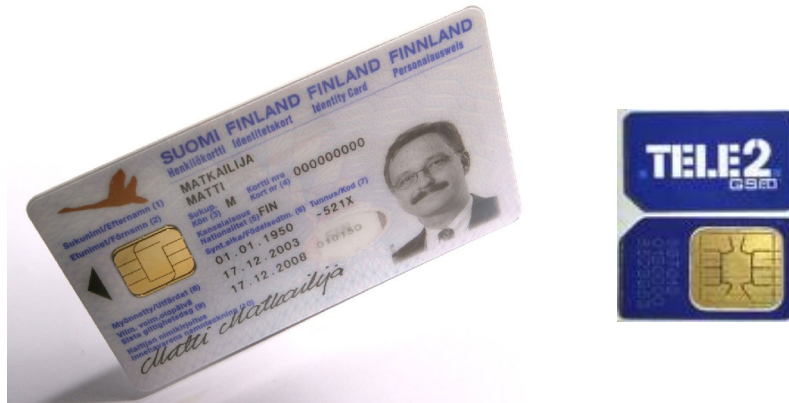
Kuva 6 Sirukortti ja SIM-kortti [Setec 2006; Wikipedia 2006]
