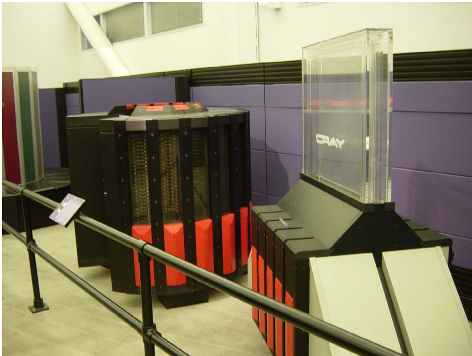
Kuva 2.2. Nestejäähdytetyn Cray-II-supertietokoneen keskusyksikkö vastaa laskentateholtaan nykyistä modernia matkapuhelinta (kuva wikipedia).
