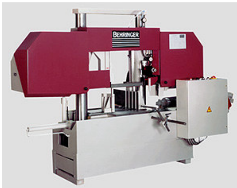
Kuva 4. Behringerin B430A kaksitukinen vannesaha.
