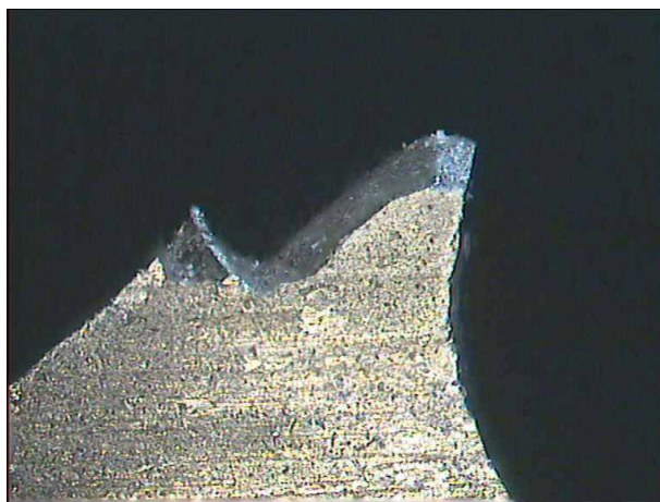
Kuva 34 .Irti lohjennut pikateräshammas sivustapäin kuvattuna.
