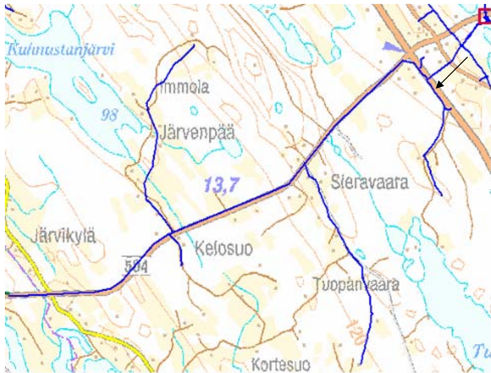
Kuva 4.6. Ahmoavaaran lähtö J08-Kuhnusta saneerattuna tien varteen. Tehon syöttösuunta merkattu suuntanuolella.
