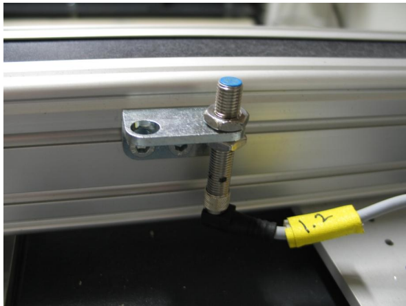
Kuva 3.7 Induktiivinen lähestymiskytkin. Anturin lisäksi johteella liikkuvaan kelkkaan on kiinnitetty so-piva magneettisesti johtava vastakappale.
