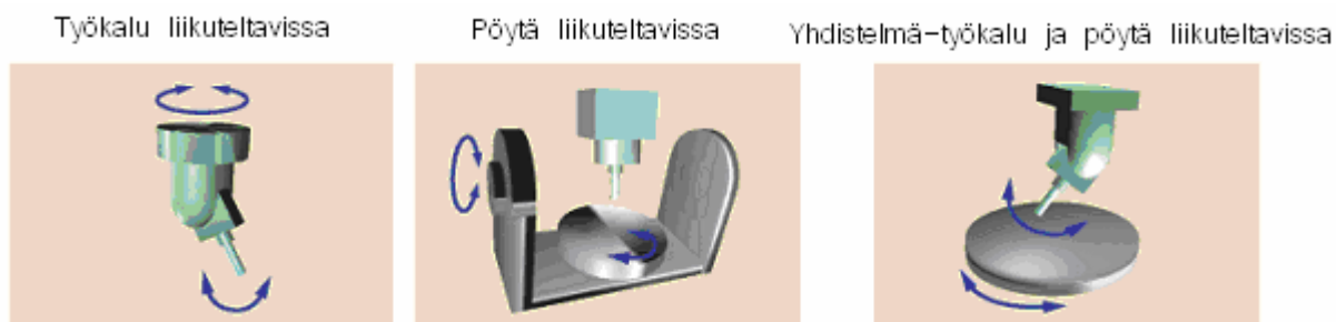
Kuva 9. Viisiakselisen työstön vaihtoehtoisia toteutustapoja. (Flexible Support of Various Mechanical Configurations.)
