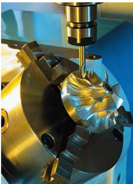
Kuva 10. Kappaleen valmistusta viisiakselisella jyrsinnällä (CNC Series 30i/31i/32i).
