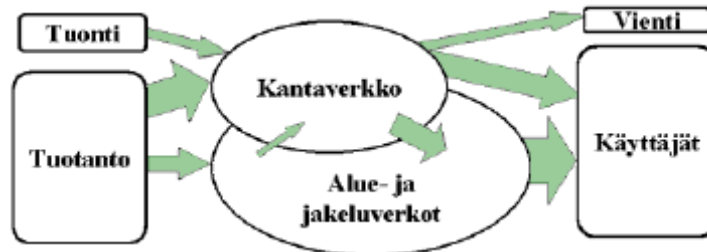
Kuva 8. Toimijarakenne sähkön siirrossa. (Partanen & al. 2007)
