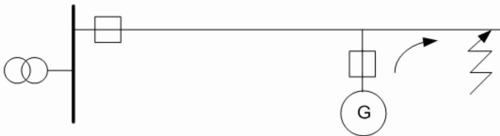
Kuva 3.6. Johtolähdöllä sijaitseva pienvoimalaitos syöttää vikavirtaa vikapaikkaan pienentäen sähköaseman kokemaa vikavirtaa, jolloin sen suojaus ei havahdu.
