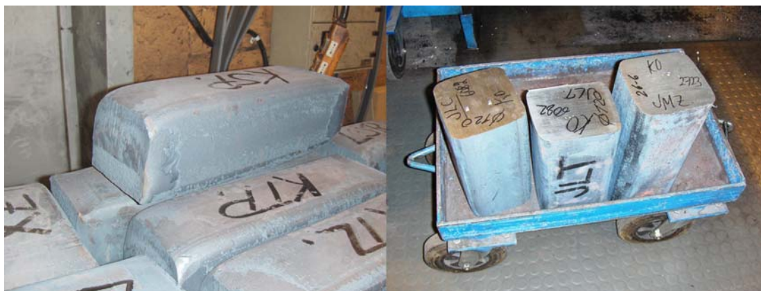
Kuva 3. Lastuttavuuskokeeseen tulevia teelmiä ennen päiden oikaisua ja teelmiä päiden oikaisusahauksen ja kovuuslaikkojen sahauksen jälkeen.
