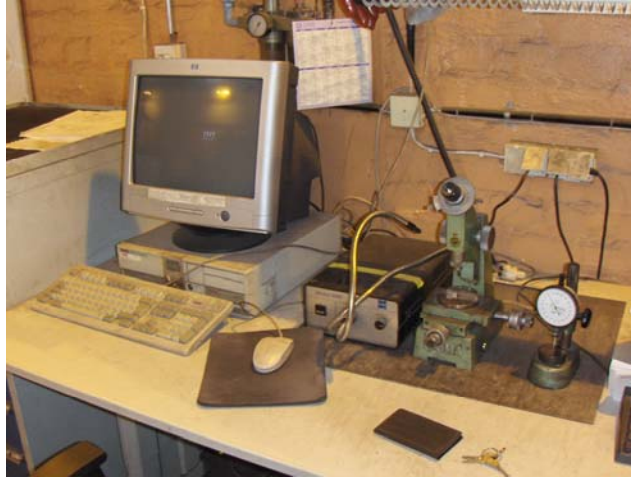
Kuva 8. Tietokone lastuamisnopeuden ja -ajan määrittämistä sekä koetulosten syöttämistä varten. Lisäksi kuvassa on työkalumikroskooppi viistekulumisen mittaamiseksi ja mittakello kuoppakulumisen mittaamista varten.
