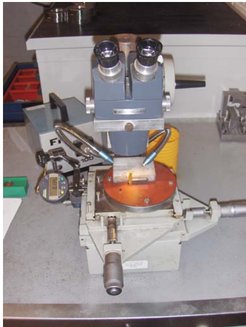
Kuva 43. Työkalumikroskoopi American Optical, mittakello Mitutoyo ja magneetilla tuettu teräpala mittausta varten.
